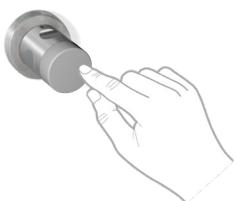
Der selektive Modus wird verwendet für die Freischaltung von Funktionen und für die Initialisierung / den Werksreset. Zur Aktivierung wird der mittlere Touchpunkt so lang gedrückt, bis die LED in der Farbe blau leuchtet. Dabei wechselt die LED von anfangs grün zu gelb und anschließend zu blau. Anschließend den Touchpunkt loslassen. Der Modus ist für 6s aktiviert, was mit blinken von 4xblauen LEDs signalisiert wird.
