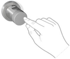
Die Funktion kann nach der Authentifizierung und Freigabe (kurze grüne LED) ausgeführt werden, sofern die EMA bereits bei der Authentifizierung unscharf / deaktiviert war. Zur Aktivierung wird der mittlere Touchpunkt so lang gedrückt, bis die LED in der Farbe cyan leuchtet. Anschließend den Touchpunkt loslassen. Sofern die Anzeige nicht erscheint, verfügt der Benutzer / das Identmedium nicht über das Recht zur Aktivierung.
